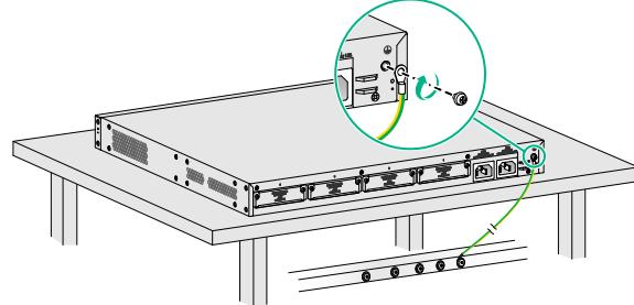
设备安装在机柜时，要求机柜已经良好接地。
